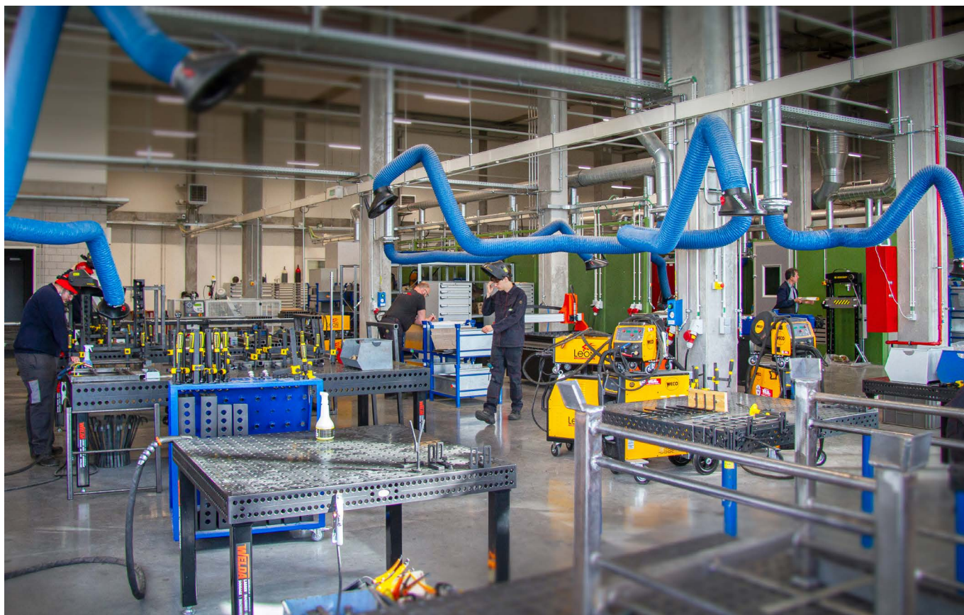
De ruime werkplaats biedt naast plaatbewerkingsmachines en lasuitrusting onder meer ook plasmagenitreerde constructietafels
