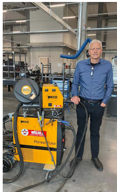
Jos Loridan (algemeen directeur VTI Brugge) naast een multifunctioneel watergekoeld lastoestel inverter 3x400V met aparte draadafwikkelaar
