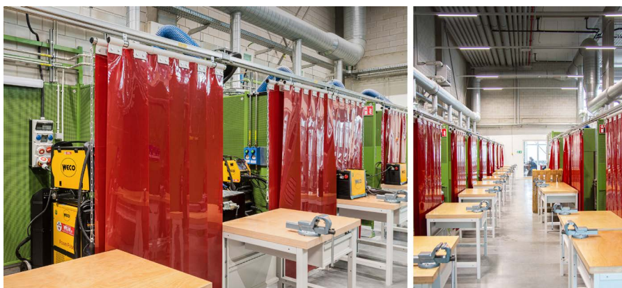
In de 26 lascabines staan multiprocestoestellen waarmee leerlingen meerdere lasprocessen op hun werkstuk kunnen uitvoeren.
