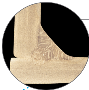
Inomaxx® Plus MAG-hoeklas in 6mm dik AISI 316L roestvast staal
